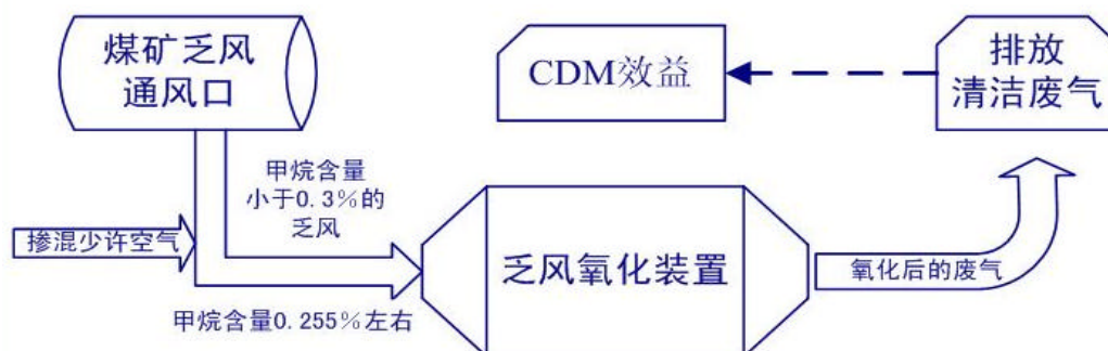
图 2 煤矿通风瓦斯氧化技术
